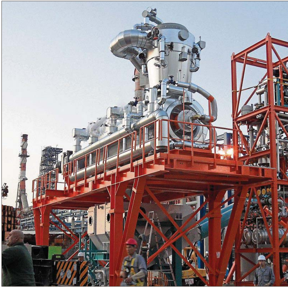
Durch Einsatz neuester Sensorik zur Erkennung der Abfallchargen arbeitet die VacuDry-Anlage mit optimal niedrigem Energieeinsatz. FOTO: ECON INDUSTRIES
