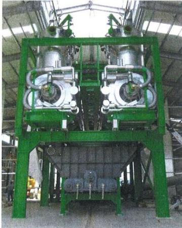
renden Welle angebracht sind, sorgen für eine intensive Durchmischung des Materials während des gesamten Prozesses und sorgen so für eine äußerst effiziente Wärmeübertragung auf das Produkt. Die Energieeffizienz liegt dabei bei über 80 Prozent. Dies ermöglicht kurze und energiesparende Chargenzeiten.
