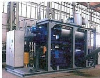
Dampf, Thermalöl oder Strom beheizten Trocknern. Die Verunreinigungen, z. B. mit Kohlenwasserstoffen und Quecksilber belasteter Boden, werden sorgfältig mittels Hitze und Vakuum von den Feststoffen getrennt, indem Sie zum Sieden gebracht und in Gas gewandelt werden. Das Gas wird anschließend in einem geschlosse-
